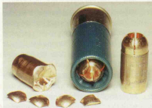
La Remington Copper Solid s'expande à l'impact en libérant quatre fragments de cuivre de grande taille; le noyau principal, un cylindre de cuivre dur, continue sa pénétration. Elle produit le plus petit diamètre de cavité mais une pénétration de 27".
