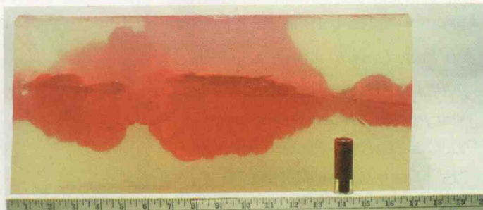
L'expansion de la Federal Barnes-X est la plus impressionnante de toutes les balles pour fusil de police (1.40"); cette balle en cuivre doux conserve également 100% de son poids (pas de perte de matière). La cavité obtenue est caractérisée par un grand diamètre et une pénétration limitée: la largeur du diamètre de l'expansion du projectile en freine la pénétration.
